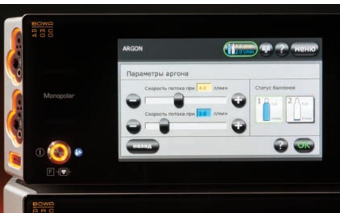
Легко читаемый пользовательский интерфейс позволяет быстро и просто устанавливать самые различные параметры аргона.
