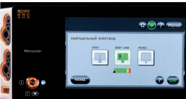
Все под контролем (индикатор в зеленой зоне)? Следование за нейтральными электродами, показанное здесь в настройках для детей (макс. 50 ватт), обеспечивает непрерывное предоставление информации о состоянии.
