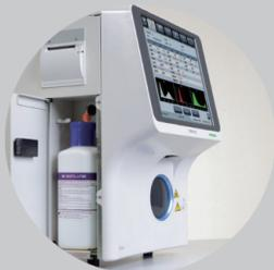
Анализаторы имеют компактный дизайн, занимая на столе площадь, сравнимую с размером 17-дюймового ноутбука. Лизирующий реагент размещается внутри анализатора, что позволяет не занимать лишнее пространство в лаборатории. Большой сенсорный дисплей позволяет легко управлять анализатором и комфортно воспринимать отображаемую информацию.
